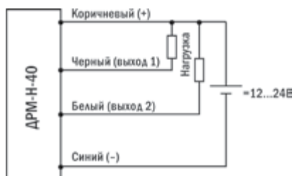
Подключение прибора с двумя NPN-выходами
