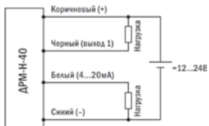
Подключение прибора с NPN и токовым выходом
