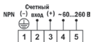
Подключение активного датчика
