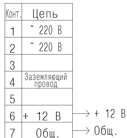
Рисунок 2. Схема подключения газоанализатора при питании напряжением ( 12^{+3}_{-1} ) В от аккумулятора или бортовой сети
