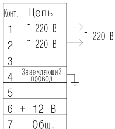
Рисунок 1 - Схема подключения газоанализатора к электрической сети питания переменным однофазным током с напряжением ( 220^{+22}_{-33} ) В и частотой ( 50 \pm 1 ) Гц
