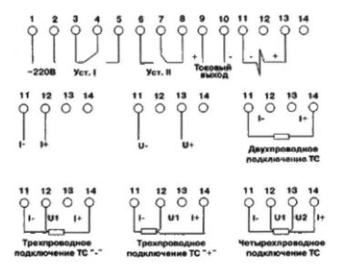
Внимание! На микропереключателе, расположенном на задней панели ИРТ, переключатели, соответствующие данной схеме подключения первичного преобразователя (указанные ниже), установить в верхнее положение "ON"
