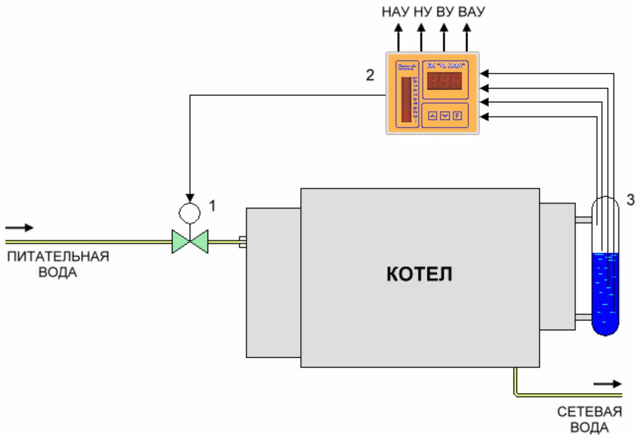
Рис. 2 Схема регулирования уровня воды в барабане котла с электродной уровнемерной колонкой
