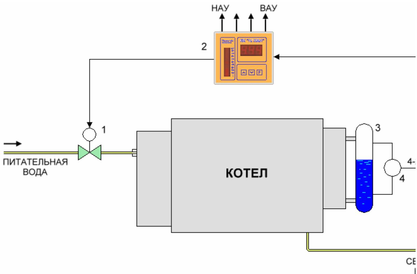
Рис. 1 Схема регулирования уровня воды в барабане котла с дифманометром на выходе уровнемерной колонки
