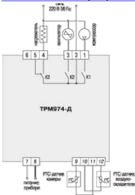
Схема подключения прибора ТРМ974-Щ
