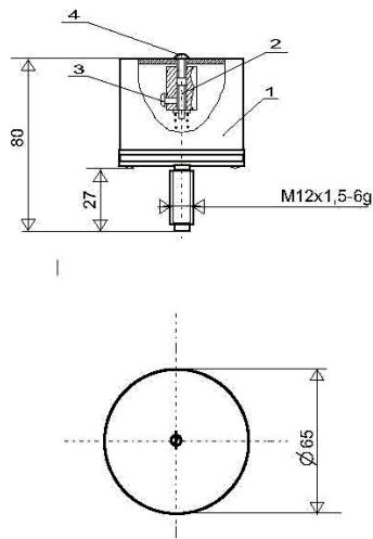
Рис.1 – Общий вид датчика ДДМ-4Р
