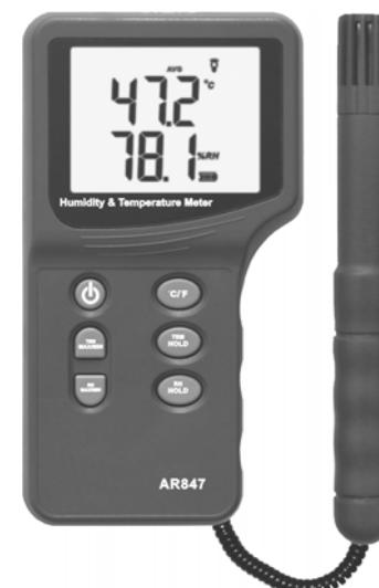
Измеритель температуры и влажности AR847 предназначен для измерения температуры и влажности воздуха. Прибор может применяться в лабораториях, на складах, в системах кондиционирования воздуха, для контроля параметров окружающей среды и т.п.
