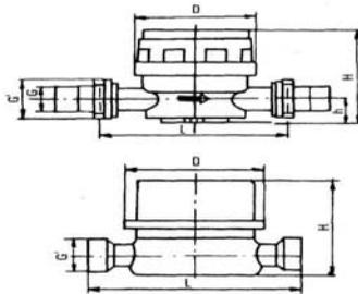
**СЧЕТЧИКИ ВОДЫ КРЫЛЬЧАТЫЕ ВСХ, ВСХ<sub>д</sub>, ВСГ, ВСТ Ду 25-40 мм.**
