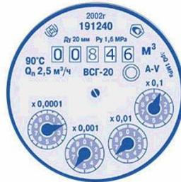
На рисунке показан счетный механизм счетчика воды ВСГ-20. Показания роликового индикатора составляет – 846, первого стрелочного указателя – 0, второго стрелочного указателя – 6, третьего стрелочного указателя – 6, четвертого стрелочного указателя – 2. Измеренный объем равен  $846,0662\text{ м}^3$ .
