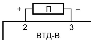
Примечание: ВТД-В обеспечивает питание (ток) выходного каскада преобразователей с частотным (импульсным) сигналом от собственного источника питания. При использовании преобразователей расхода с частотным (импульсным) сигналом напряжения (например, UFM-001, ИПРЭ-7) амплитуда импульсов должна быть в пределах: 0 – 1 В (низкий уровень), 4 – 6 В (высокий уровень). Для этого можно подключить на выходные клеммы расходомера нагрузочное сопротивление  $R_n = 620 \text{ Ом}$ , 0,125 Вт.
