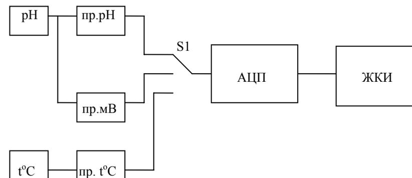
Рис. 1. Структурная схема рН-метра “рН-1014”
