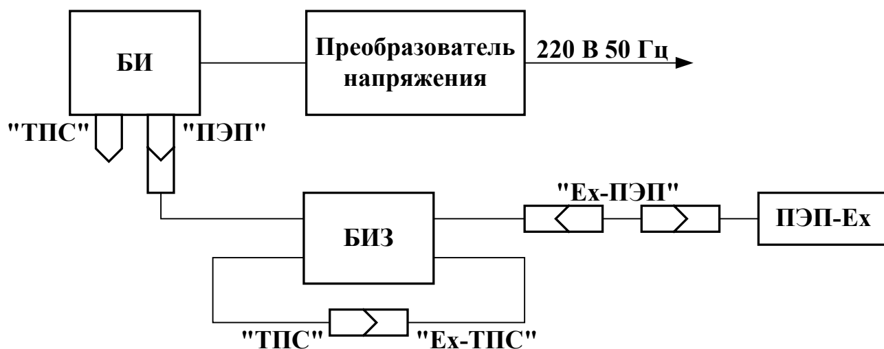
Рис.Б.3. Схема подключения УР-Ех / РСЛ-Ех без использования ТПС.
