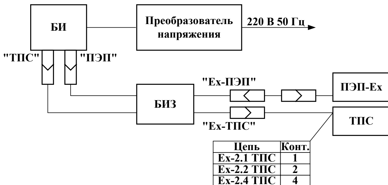
Рис.Б.2. Схема подключения УР-Ех / РСЛ-Ех с использованием ТПС.
