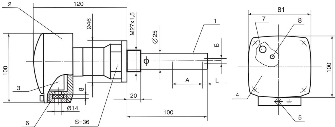
А, Б-рабочая зона, соответственно, при вертикальной и горизонтальной установке
