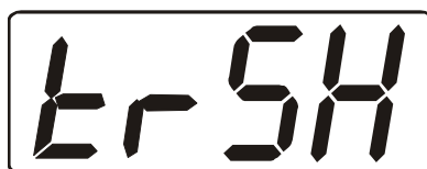
Рис. 7. Вид индикатора при входе в режим настройки порогов.
