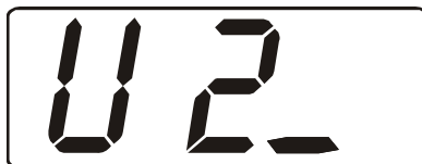
Рис. 14. Вариант настройки прибора – верхний порог по температуре выключен, вид сигнализации – тревога.
