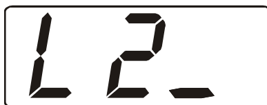
Рис. 13. Вариант настройки прибора – нижний порог по температуре выключен, вид сигнализации – тревога.
