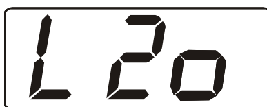
Рис. 15. Вариант настройки прибора – нижний порог по температуре включен, вид сигнализации – тревога.
