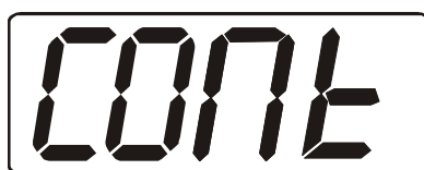
Рис. 31. Вид индикатора в случае, когда программа регулирования при отключении питания будет продолжена с момента останова.
