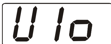
Рис. 12. Вариант настройки прибора – верхний порог по температуре включен, вид сигнализации – предупреждение.
