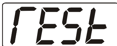
Рис. 33. Вид индикатора в случае, когда программа регулирования при отключении питания будет перезапущена с 1-го шага.
