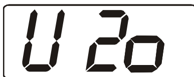
Рис. 16. Вариант настройки прибора – верхний порог по температуре включен, вид сигнализации – тревога.
