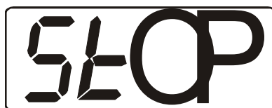
Рис. 32. Вид индикатора в случае, когда программа регулирования при отключении питания будет выключена.
