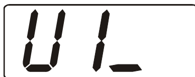
Рис. 10. Вариант настройки прибора – верхний порог по температуре выключен, вид сигнализации – предупреждение.
