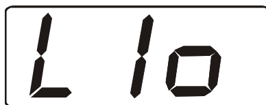
Рис. 11. Вариант настройки прибора – нижний порог по температуре включен, вид сигнализации – предупреждение.
