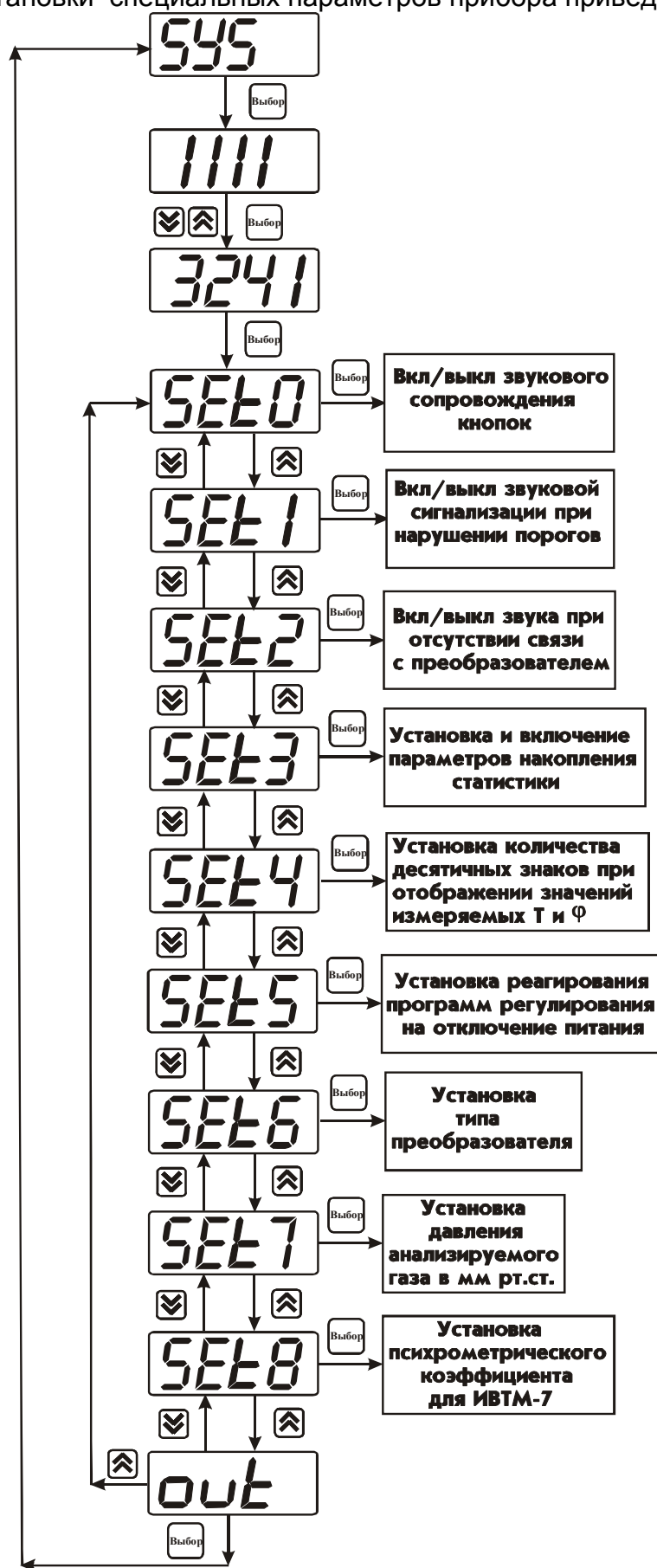
Рис. 19 Схема меню установки специальных параметров прибора
