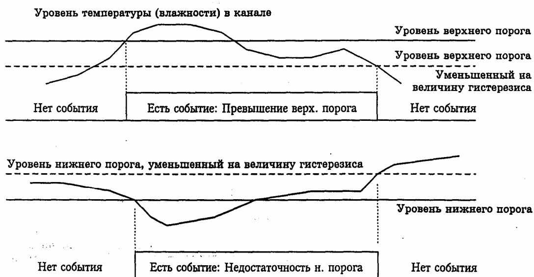
Рис. 3 Пояснение работы системы управления с зоной гистерезиса
