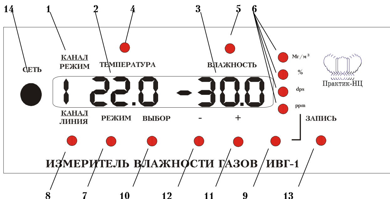
Рис. 1. Расположение элементов управления и индикации на передней панели прибора
