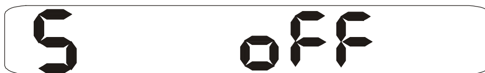
Рис. 35. Вид индикатора, когда звуковая сигнализация отключена.
