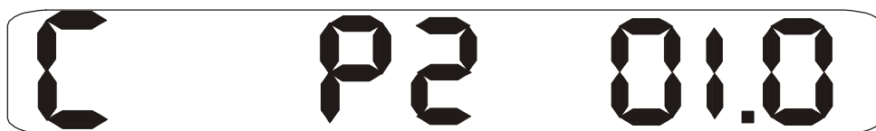
Рис. 15. Значение давления P2, при котором происходит пересчет величины влажности.
