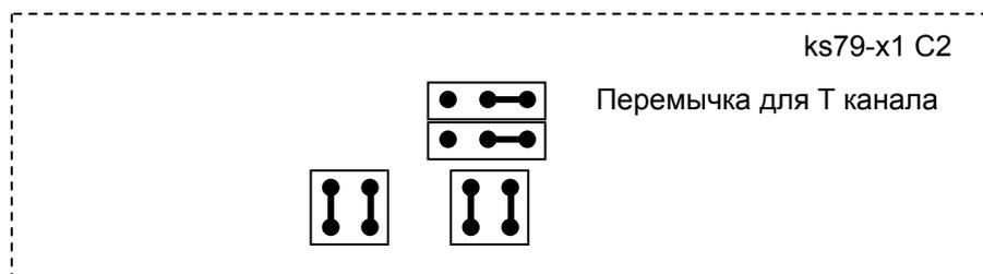
Если используется термопреобразователь с унифицированным токовым выходом, тогда необходимо установить следующее состояние перемычек (перемычки («джампера») находятся внутри ИТР на плате ks79-x1 ( $\chi=0..9$ ) со стороны C2):
