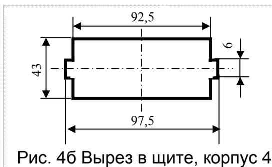
Рис. 4б Вырез в щите, корпус 48x96x155 мм.
