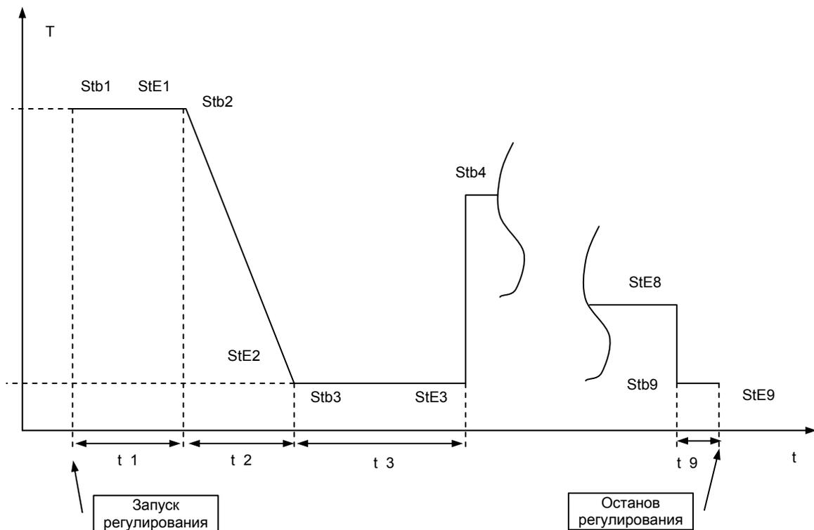
Рис. 2. Технологический цикл (для температуры).
