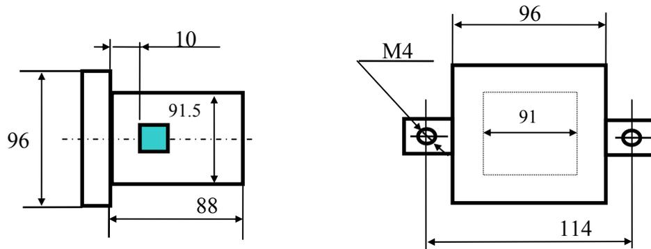
Рис. 4в Габаритные размеры, корпус 96x96x96 мм.
