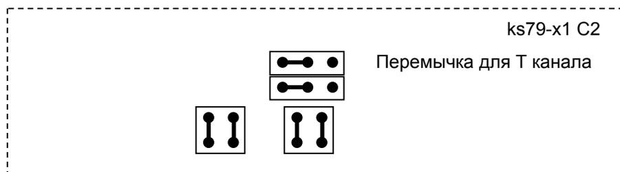
Рис.3г Схема подключения прибора с совмещенным датчиком влажности и температуры без выходного унифицированного сигнала
