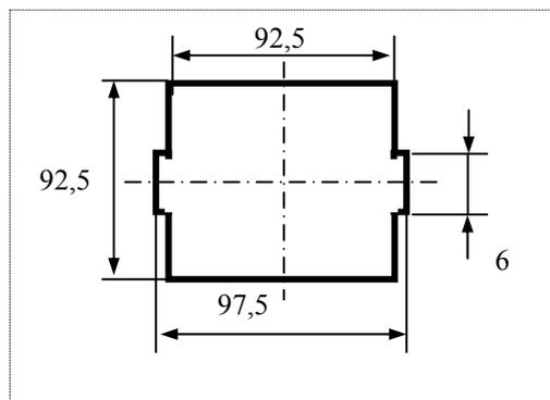
Рис. 4г Вырез в щите, корпус 96x96x96 мм.
