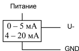
Датчик-2-х проводный термопреобразователь с унифицированным токовым выходом
