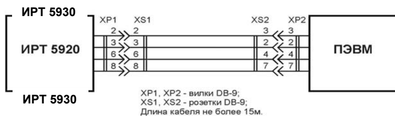
Рис. Б. 1. Схема подключения ИРТ к компьютеру в конфигурации "точка-точка" через интерфейс RS232C.
