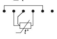
Подключение термопреобразователя сопротивления, 4-х проводная схема
