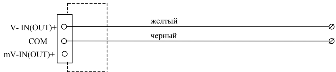
Соединительный кабель №5/2 для связи с устройствами в режимах измерения и генерации сигналов напряжения до 120 В и 12 В соответственно.
