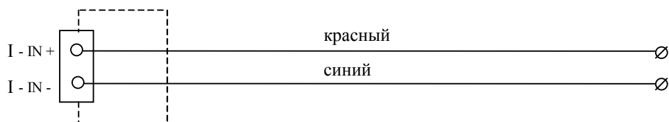
Рисунок А.6. Соединительный кабель №7 в режиме измерения силы постоянного тока.
