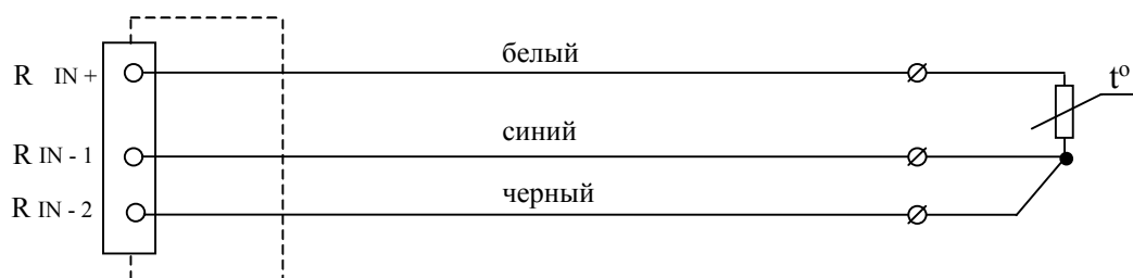
Рисунок А.2. Соединительный кабель №3 для связи с ТС в режиме измерения и для связи с устройствами по трехпроводной схеме подключения в режиме воспроизведения сигналов от ТС.
