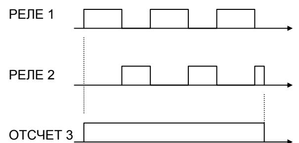
Очевидно, что в последовательном режиме невозможна работа реле с функцией ручного сброса его состояния.
