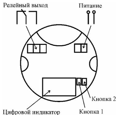
Рис.3 Схема подключения
