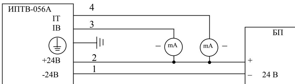
**Примечание.** Неиспользуемый токовый выход (IT или IB) соединяют с клеммой +24 В БП.
