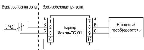
Цепь С (клеммы 3, 9) включается в общий провод датчика ТС. Цепь В (клеммы 2, 8) включается в цепь источника тока вторичного преобразователя. Цепь А (клеммы 1, 7) включается в измерительную цепь датчика.
