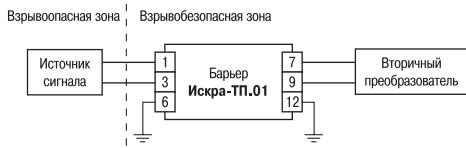
Барьер Искра-ТП.01 имеет сопротивление каждой цепи около 110 Ом. В случае использования термопары, барьер рекомендуется включать в разрыв компенсационных проводов.
