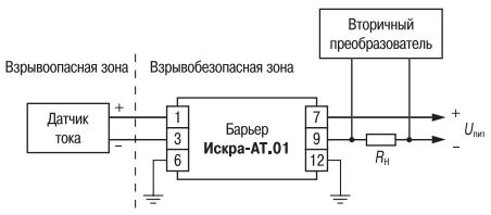
Барьер Искра-АТ.01 используется с источником постоянного напряжения, имеющим максимальное выходное напряжение 28 В и обеспечивающим выходной ток 40 мА.
