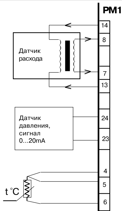
Рис. В.5. Схема подключения датчиков при измерении расхода газа (пара), давления, температуры
