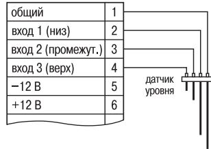
Рис. Б2. Схема подключения кондуктометрических датчиков уровня
