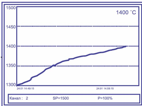
Третий режим – режим вывода на экран подробной информации по одному из каналов. В этом режиме выводится информация о программе – номер программы, номер шага и состояние, график процесса и текущее время, а также закон регулирования и уставка.
