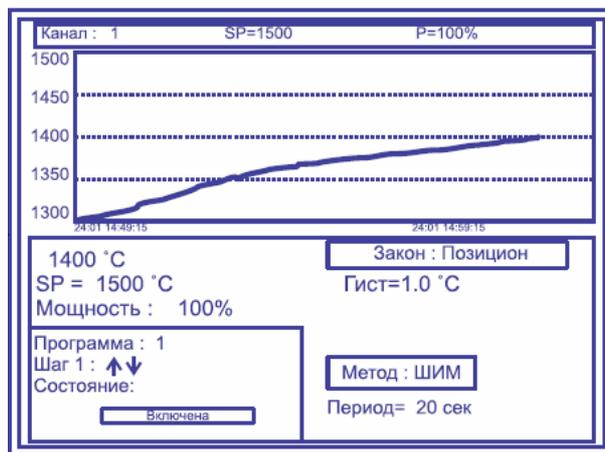
**Примечание** – Чтобы показания, символизирующие обрыв датчика, не мешали наблюдению, советуем на неиспользуемые входы вместо термодатчиков подключить закоротку – кусочек проволоки или канцелярскую скрепку. Прибор будет при этом показывать свою собственную температуру, близкую к температуре воздуха или чуть выше. Ещё лучше - выключить неиспользуемые входы. Этому можно научиться, изучив инструкцию.
