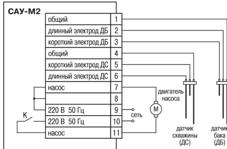
**Рис. Б. 1. Подключение SAU-M2 при использовании для заполнения резервуара с помощью погружного насоса с защитой от "сухого хода"**
