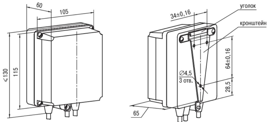
Рис. А.1. Корпус настенного крепления типа Н
