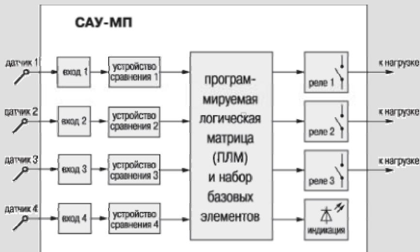
САУ-МП содержит 4 входа для подключения датчиков, 4 устройства сравнения, выполненных на операционных усилителях, программируемую логическую матрицу (ПЛМ) для обработки данных, набор базовых элементов и три выходных электромагнитных реле.
