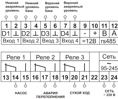
Рис. 5.7 Алгоритм 4: схема подключения
