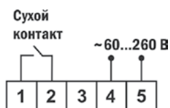
Подключение «сухого контакта»
