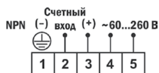
Подключение активного датчика
